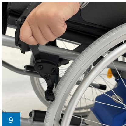
9 Räder des Rollstuhls einbremsen
